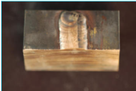
W164 – Navařování podélného svaru
