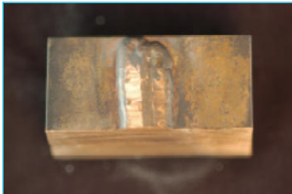
W200 - Navařování podélného svaru
